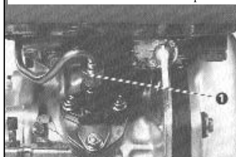
1. Tuerca del tubo de combustible de alta presión
